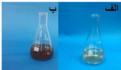
شکل ۱ - تغییر رنگ محلول واکنش قبل از تولید شدن نانوذرات نقره (الف) و پس از ۲۴ ساعت و تولید شدن نانوذرات نقره (ب).
