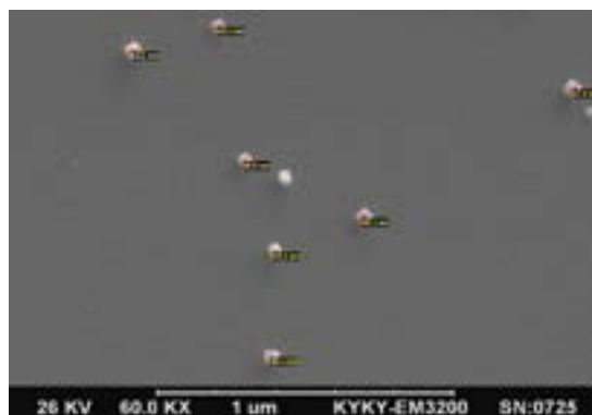
شکل ۲ - تصویر میکروسکوپ الکترونی از نانوذرات مگنتیت با ساختار مکعبی (بزرگنمایی X ۶۰).
